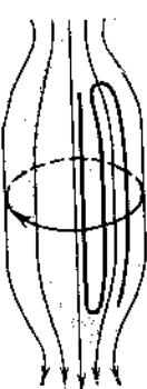
Рис. 2.5. Осевая линия траектории частицы в поле с магнитными пробками
