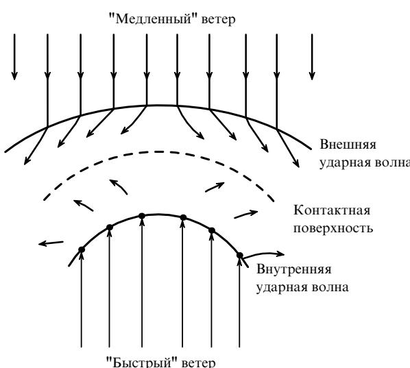
**Рис. 2.** Двойная структура ударной волны, возникающая в результате столкновения быстрого потока с более медленным. Стрелками показано направление линий тока в системе отсчёта, связанной с фронтом головной ударной волны.
