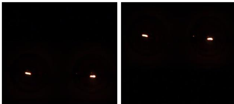
Рис. 5. Пример двух кадров с максимальным отклонением (размахом). Разряд в водороде, баллистический маятник в третьей секции (95 см). Размах колебаний 14 мм, что соответствует импульсу \sim 1,5 \cdot 10^3 г·см/с
