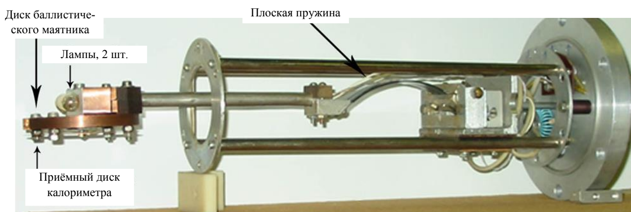
Рис. 3. Фотография баллистического маятника-калориметра
